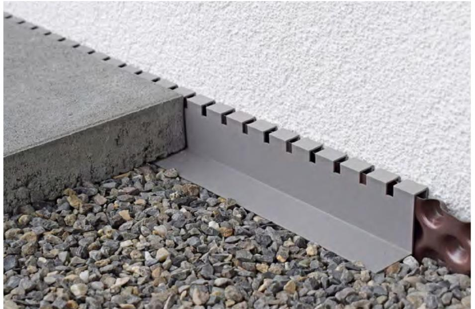
Das Fassadenabschlussprofil ermöglicht eine saubere und unauffällige Distanz zwischen den Gartenplatten oder Pflaster- bzw. Verbundsteinen und der Außenwand. Dank der Lasche, die unter den Belag reicht, bleibt das Profil in Position und wandert mit der Zeit nicht aus der Fuge heraus.
